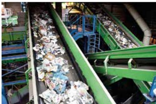
La ligne de traitement de la collecte sélective permet l'extraction des matériaux recyclables avant leur expédition vers les filières de recyclage. À l'issue de ce tri, les déchets n'ayant pu faire l'objet d'une valorisation sont acheminés vers l'usine d'incinération voisine pour produire du chauffage et de l'électricité.
